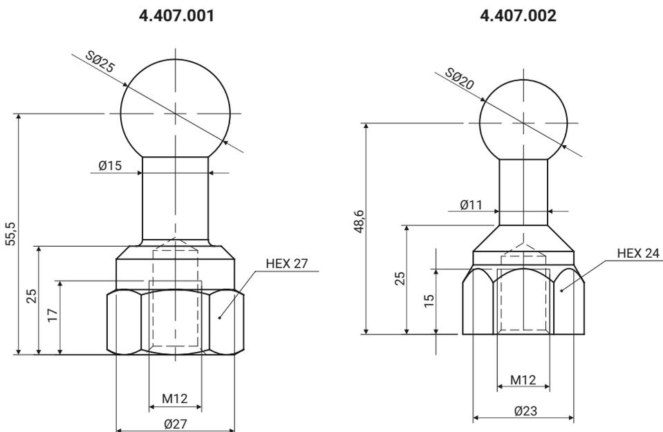
Шариковые болты установлены на силовых шинах, электрических проводах или других элементах энергетических устройств, используются для установки фазовых зажимов заземления на шариковые болты.
