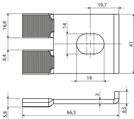
Соединитель предназначен для V-клем HS 10-95 (стр. 4-6)
