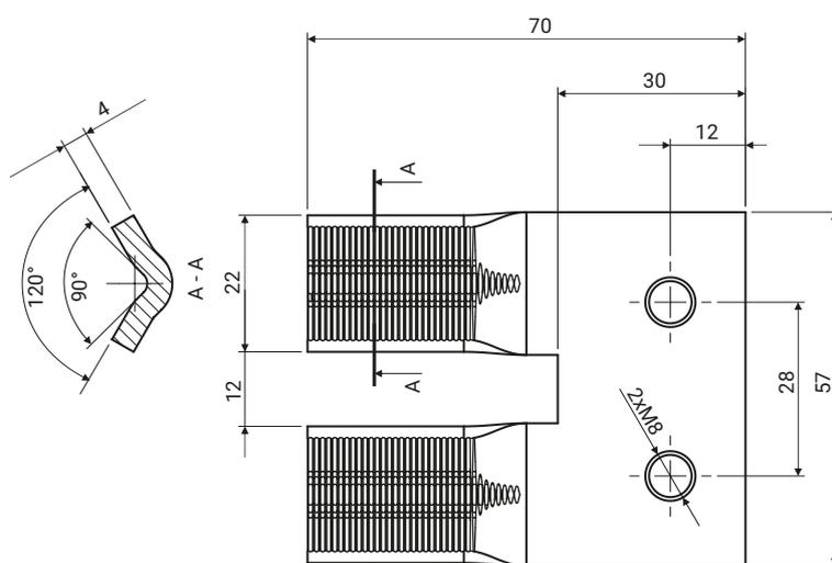
Соединитель предназначен для V-клем из страниц: 4-1 кроме 25-120 SW, 25-120 SW-B; 4-2 кроме 2,25-120 SW, 2/25-120 SW-B; 4-7; 4-8.
