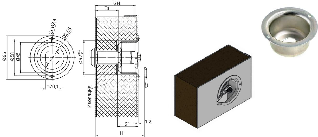
Адаптер к замкам типа M22 уменьшает монтажную толщину двери для дверей с изоляцией
