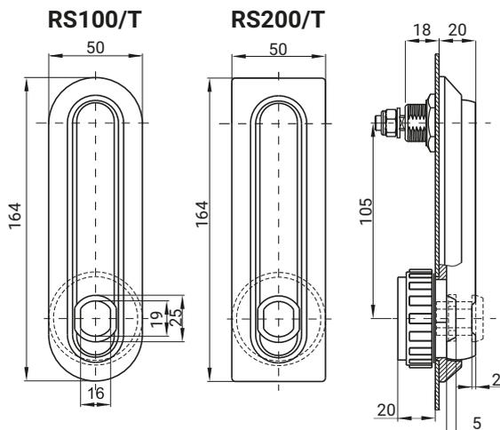
Форма и размер отверстий для установки замка
