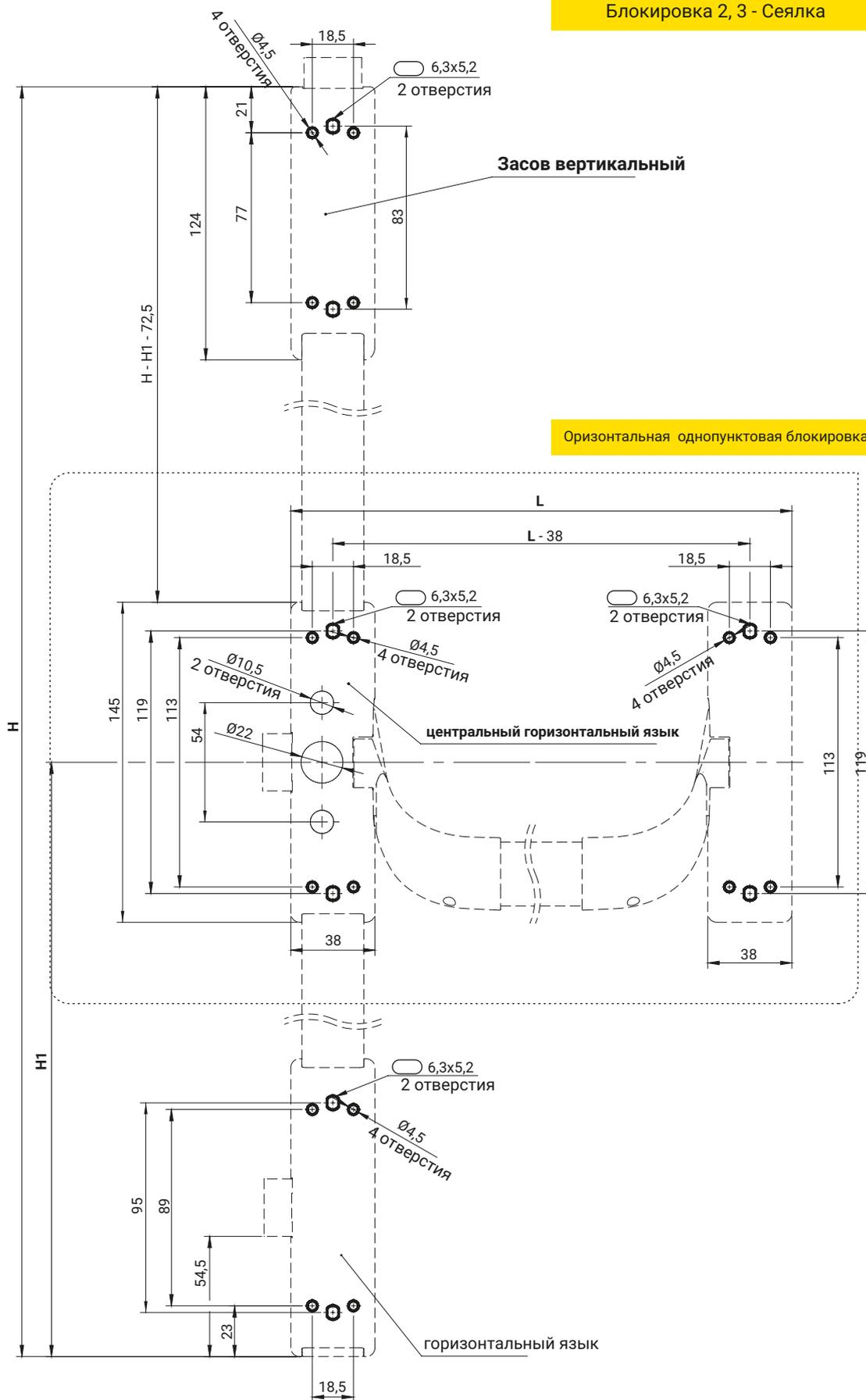
Каждый с языков можно установить при помощи 4 отверстий  $\varnothing 4,5$  или 2 отверстий 6,3x5,2
